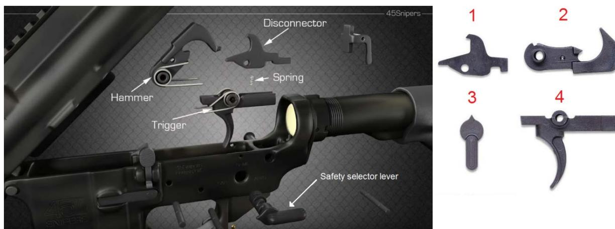
Рисунок 1. Компоненты переводчика огня штурмовой винтовки AR-15.
