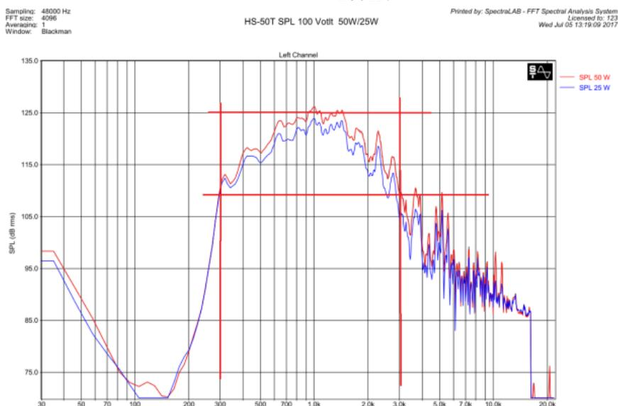
Рисунок 1. ЧХЗД рупорного громкоговорителя HS-50T, при подведении к нему мощностей 25/50Вт.
