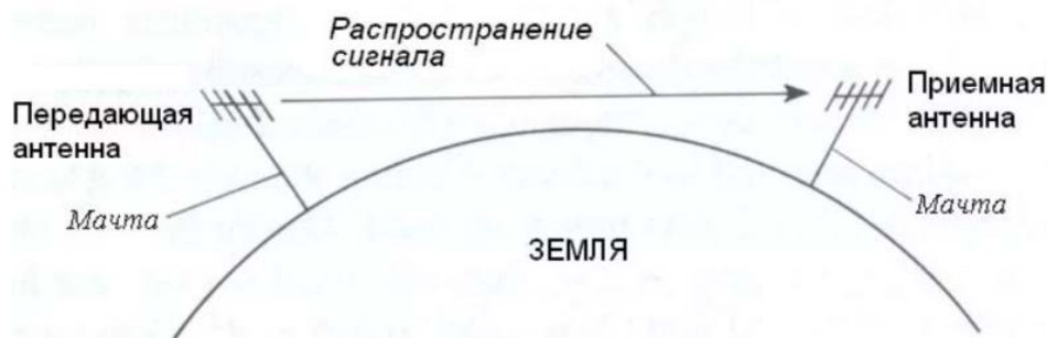
Рисунок. Схема распространения волн в пределах прямой видимости.
