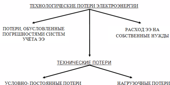
Рисунок 1. Технологические потери сетях 10/0,4 кВ района электрических сетей (РЭС) территориальных сетевых организаций (ТСО).
