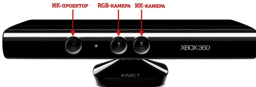
Рисунок 1. Основные элементы Kinect I.
