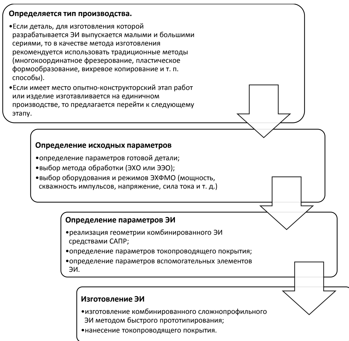
Рисунок 2. Этапы работ по проектированию и изготовлению ЭИ с поверхностями G2 и выше
