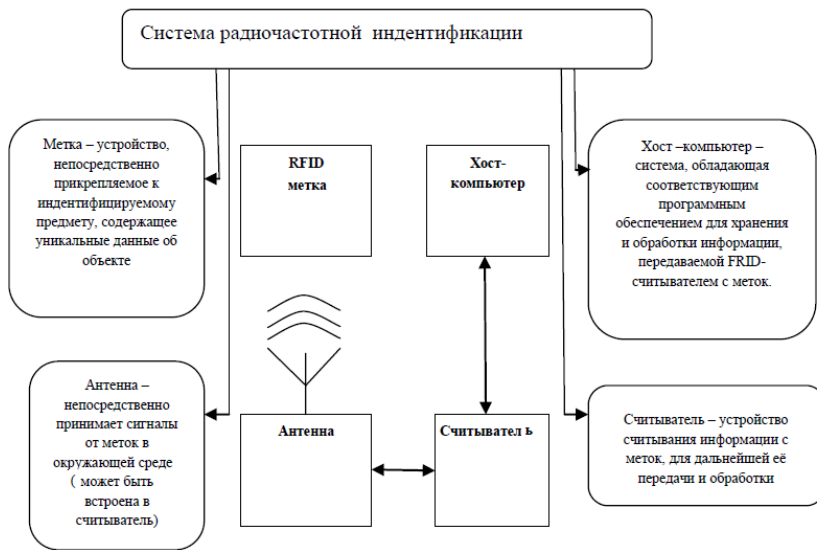
Рис. 2. Структура функционирования RFID- системы, 2 вариант
