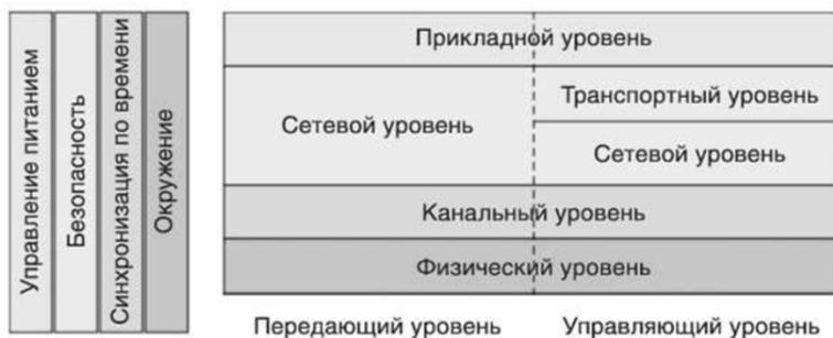
Рисунок. Стеки протоколов беспроводной сенсорной сети
