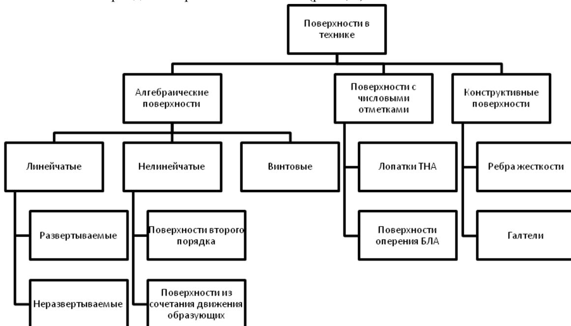
Рис. 2. Классификация поверхностей с позиции рабочего профиля
