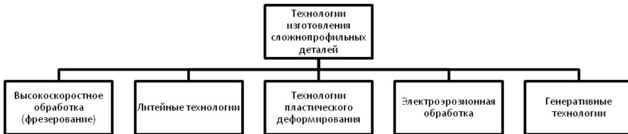
Рис. 4. Технологии изготовления сложнопрофильных деталей
