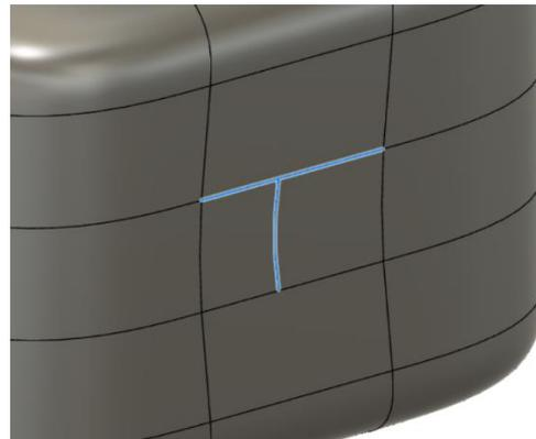
Рисунок 3. Моделирование на основе T-сплайнов
