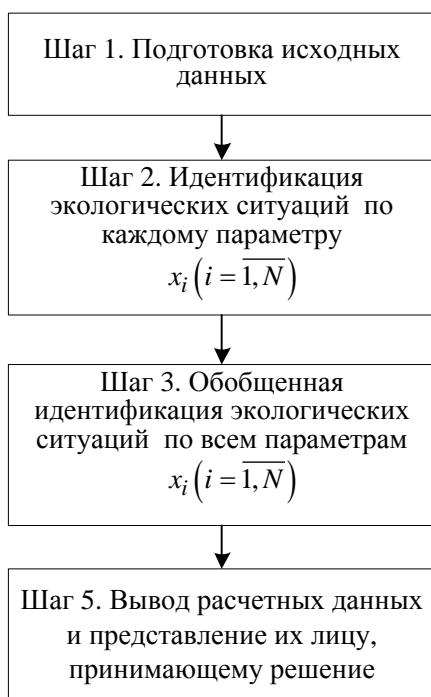
Рисунок 1. Вероятностно-статистический алгоритм идентификации чрезвычайных ситуаций, возникающих при производстве строительных работ.
