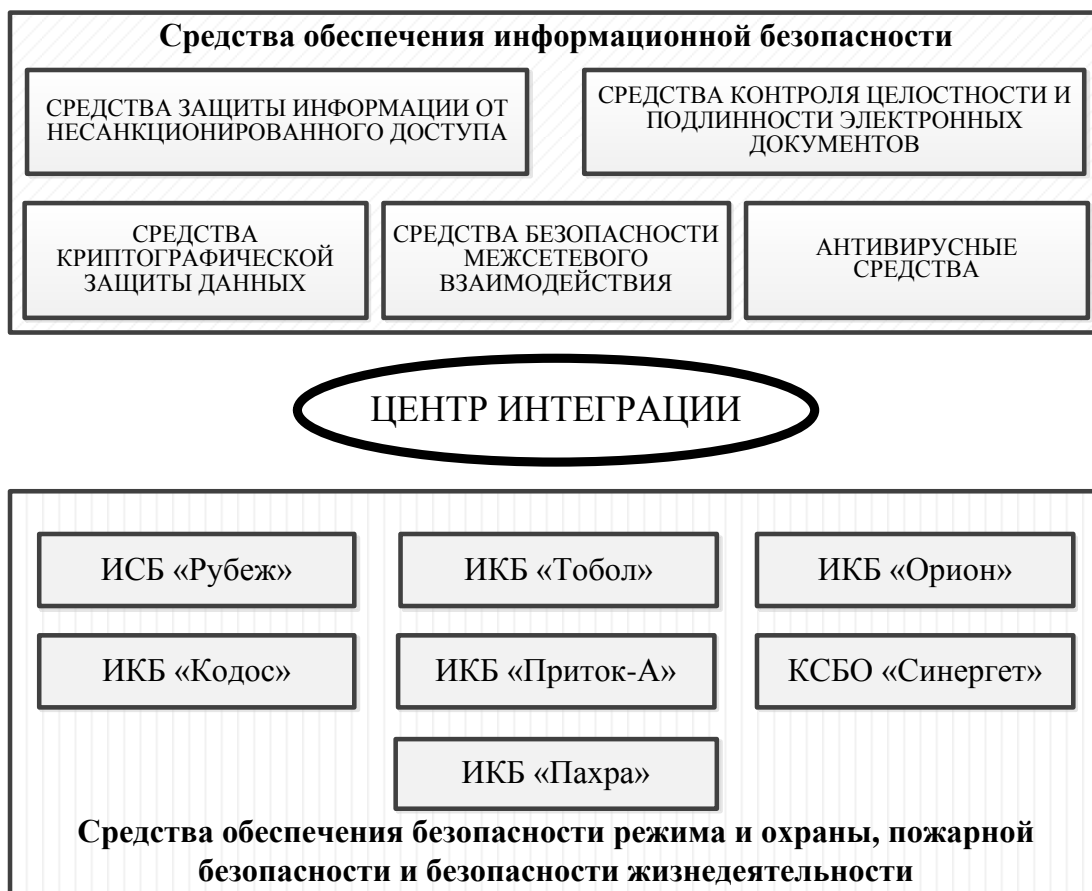
Рисунок 3. Типовой состав технических средств обеспечения безопасности критически важных объектов социальной инфраструктуры
