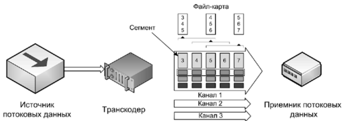
Рисунок 1. Архитектура адаптивного потокового вещания с разделением данных на множество сегментов с различными характеристиками.
