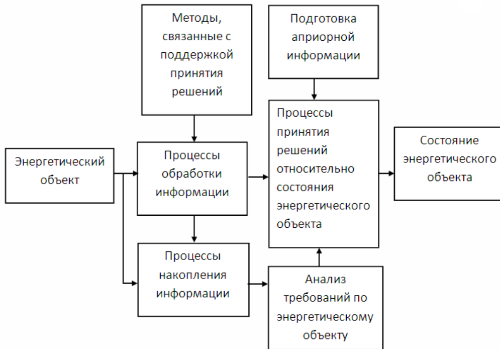
Рисунок 1. Иллюстрация структуры задачи для определения состояния энергетических систем
