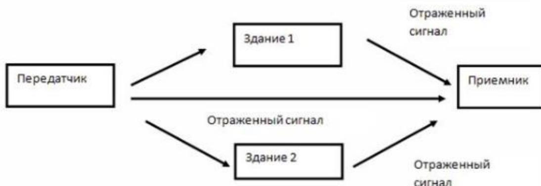
Рисунок 1. Многолучевое распространение сигнала.
