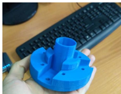
Рисунок 1. Проектирование детали «корпус»: а) 3D-модель детали, б) макет корпуса из ABS-пластика.
